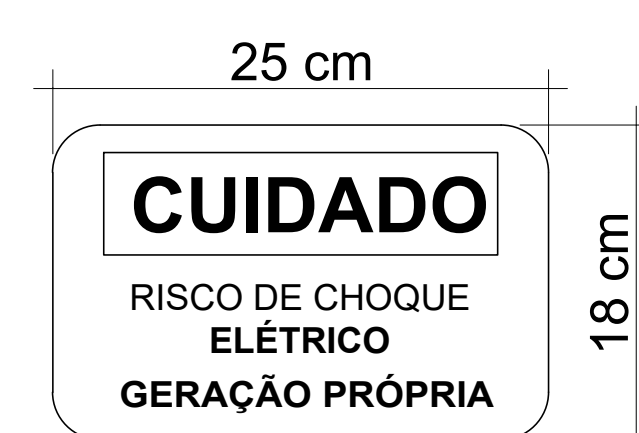
DETALHE DA PLACA DE AVISO DE GERAÇÃO PRÓPRIA
